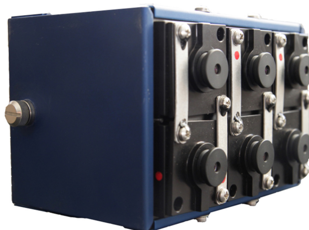
Fig 3. Tetracam Mini MCA-6 multispectral camera.
